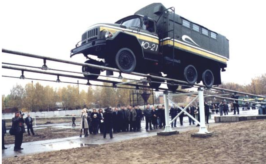
Рис. 1. СТЮ в г. Озёры Московской области, октябрь 2001 г. Имитатор модуля – модифицированный автомобиль ЗИЛ-131 весом 12 тонн
