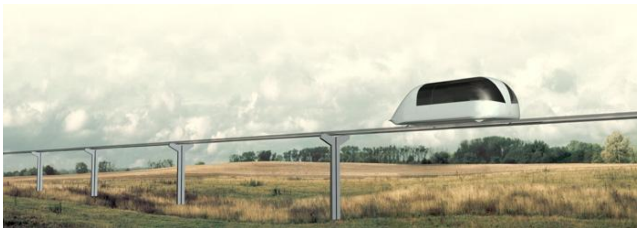
Высокоскоростной пассажирский модуль СТЮ, скорость до 350 км/ч, вместимость 15...40 чел.
