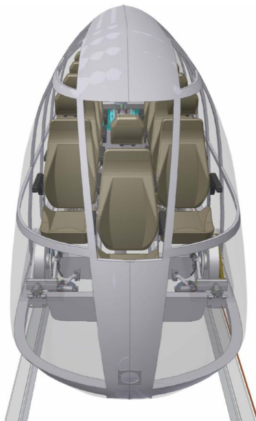
Рис. 3. Компоновка высокоскоростного юнибуса Ю-321РЕ (вид на носовую часть)
